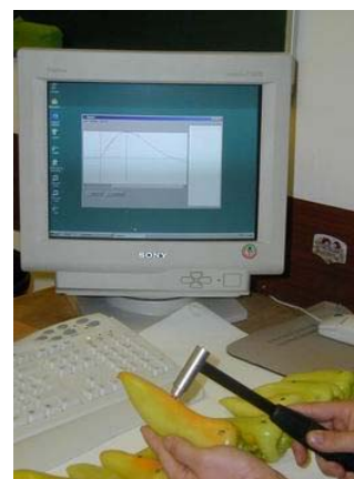
Forrás: Felföldi és Ignát (1999) 10. ábra. Az ütészvizsgálati, impakt állománymérési módszer elrendezése.
