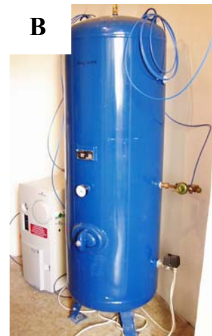
3. ábra. ICA-61 SzL-szabályozórendszer (A) és a N 2 -ellátást biztosító N 2 -generátor és N 2 -tartály (B).
