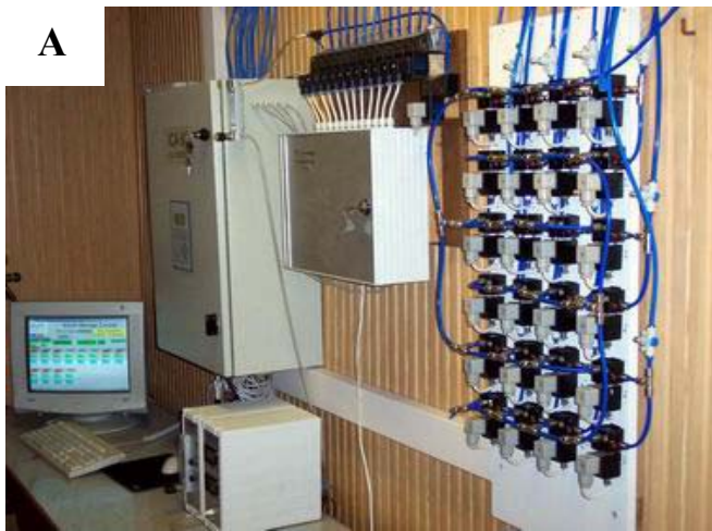
3. ábra. ICA-61 SzL-szabályozórendszer (A) és a N 2 -ellátást biztosító N 2 -generátor és N 2 -tartály (B).
