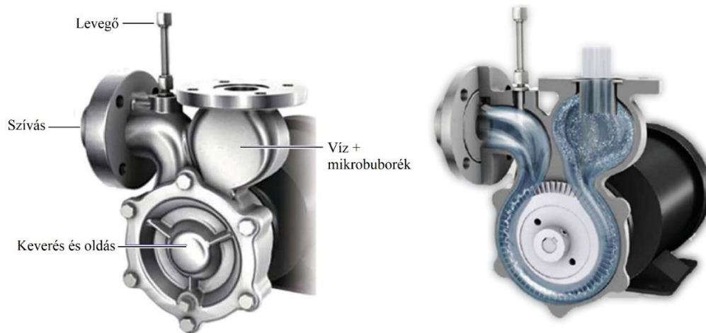
14. ábra: Többfázisú szivattyú mikrobuborék előállításához (Lu et al., (2023) alapján)
