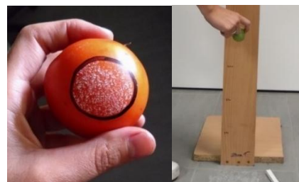
27. ábra: Az ejtészvizsgálat kivitelezése (saját forrás)
