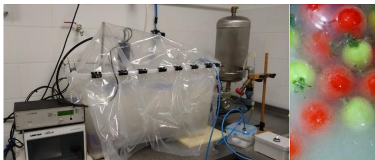
26. ábra: A mikrobuborékos 1-MCP kezelés kivitelezése (saját forrás)
