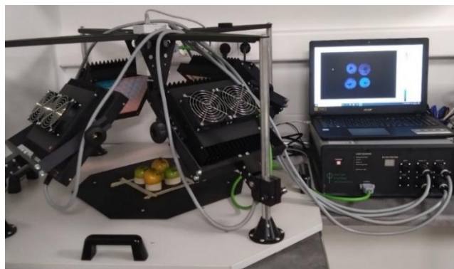
34. ábra: Open FluorCam klorofill fluoreszcenciás mérőberendezés (saját forrás)
