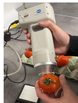
30. ábra: Színmérés a Minolta CR-400 berendezéssel
