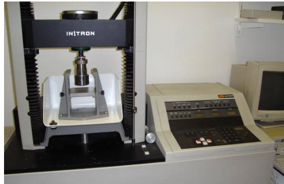
23. ábra: Instron 4302 típusú univerzális állománymérő készülék, az állományprofil analízis (TPA) során használt feltétellel (Forrás: saját, 2007)
