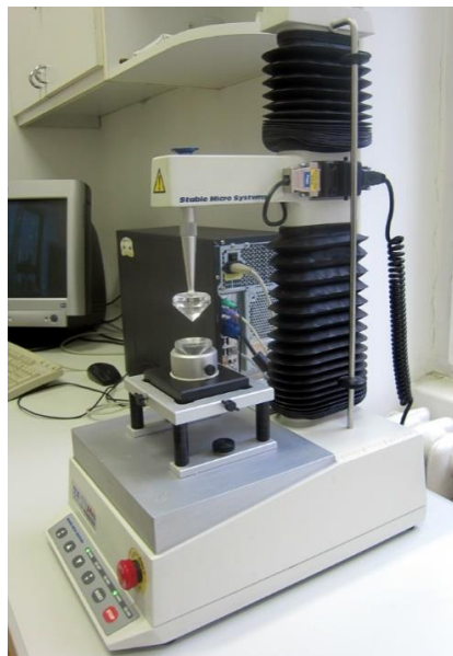
14. ábra Az SMS TA.XT Plus állománymérő készülék kúpos mérőfejjel (saját felvétel)
