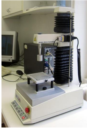
13. ábra Az SMS TA.XT Plus állománymérő készülék, joghurt gélszilárdság mérése (saját felvétel)
