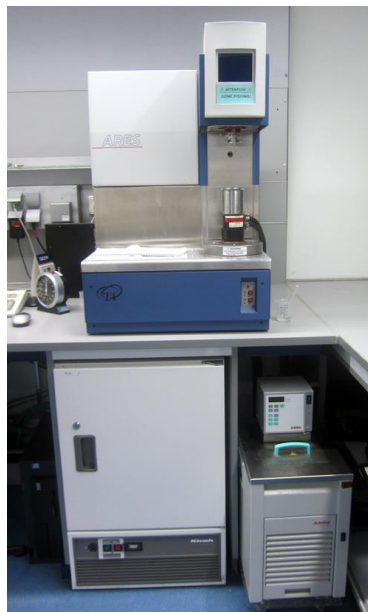
12. ábra Osszcillációs típusú ARES RFS3 reométer (saját felvétel)
